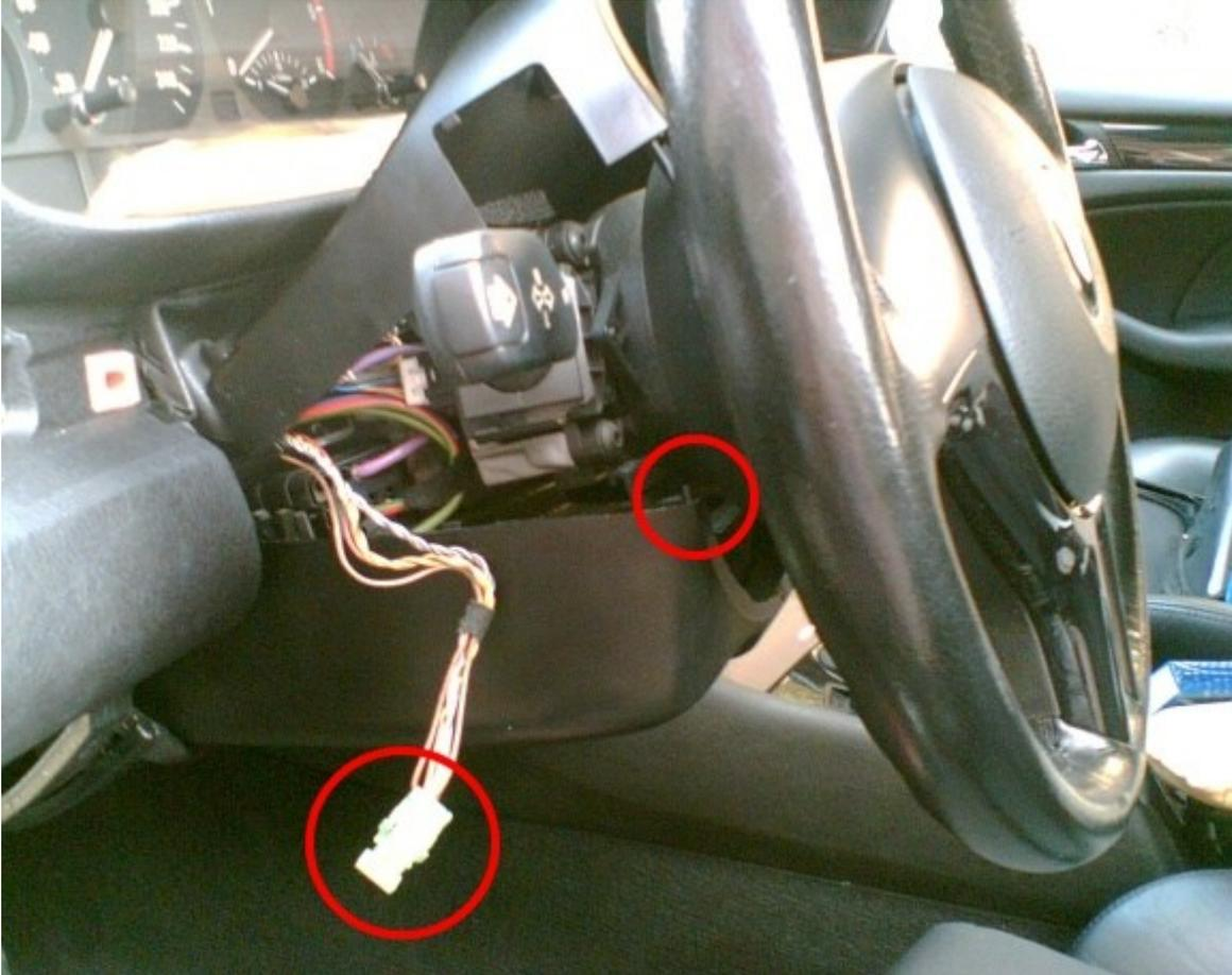
Lenkrad nach unten stellen. Für obere Abdeckung die Schraube und den Einsatz entfernen.
