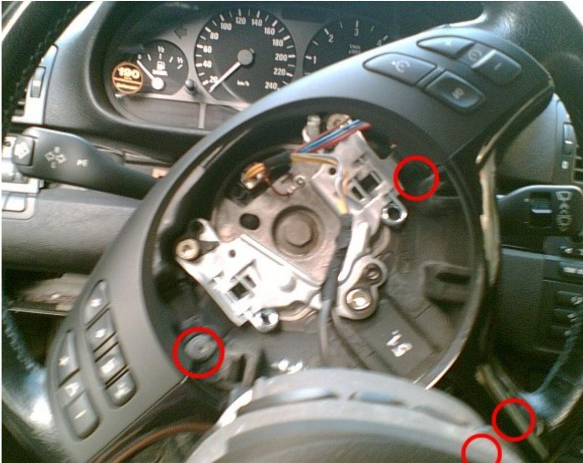
Nachdem der Airbag entfernt wurde, müssen noch die beiden inneren Schrauben mit einem Torx/Inbus entfernt werden.
