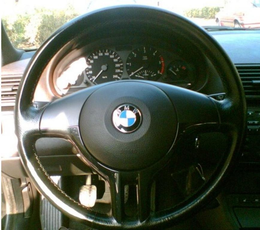
Sportlenkrad mit Radiosteuerung + Tempomat
