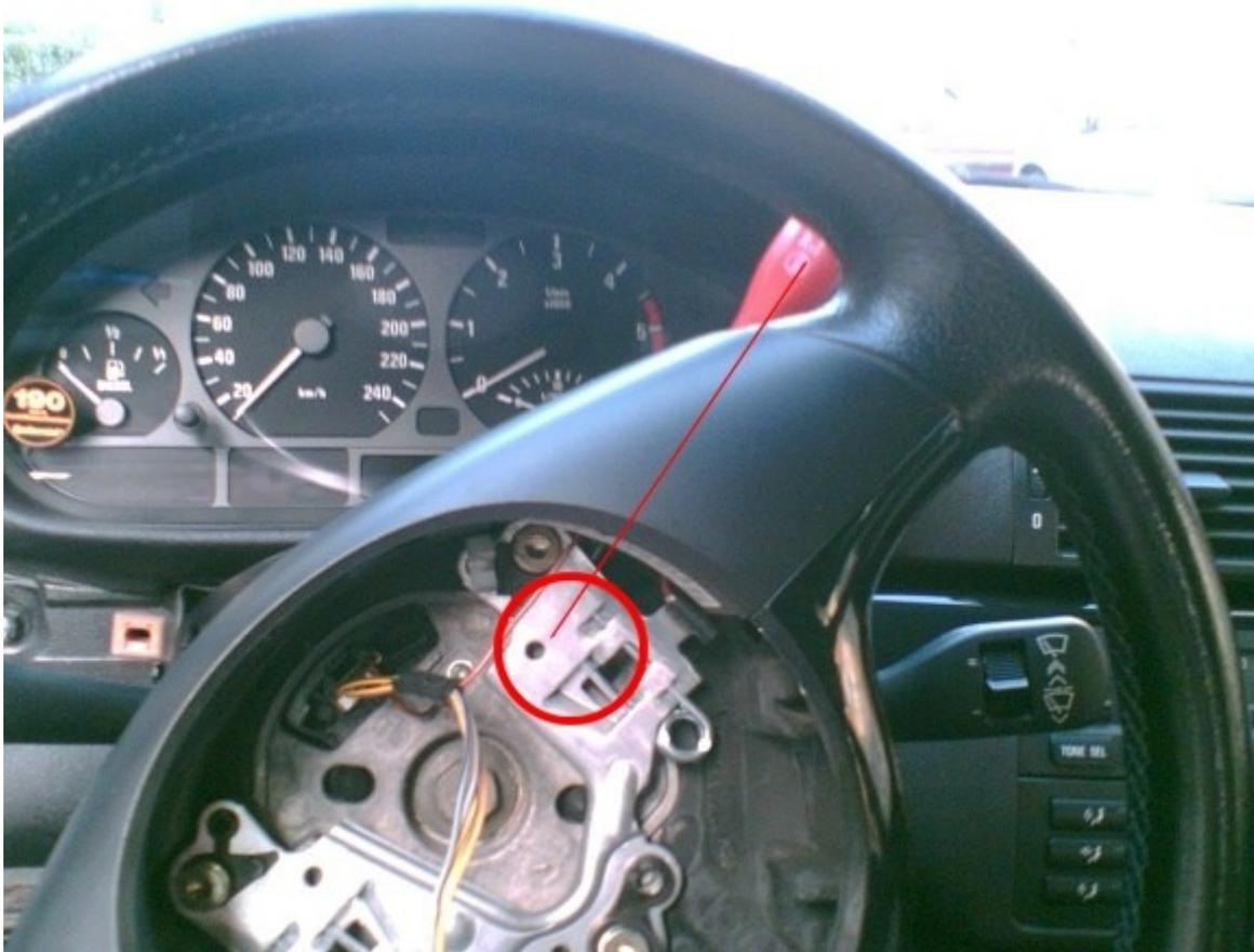
Zuvor die rückwärtigen Schrauben an den unteren Speichen mit einem Torx/Inbus entfernen.
